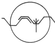
**Tipp!** Laufen die Sicken der sich gegenüberliegenden Lichtplatten konform zueinander, wird ein eventuelles Eindringen von Niederschlag durch den Spalt auf ein Minimum reduziert.
