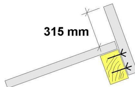
2. Schnur spannen und alle anderen Stützen ausrichten und ebenfalls mit je 2 bzw. 3 Bohrerschrauben befestigen. Der Stützenabstand ist unbedingt einzuhalten und beträgt beim Deluxe Agrar XXL **MLL 60 bis 200 - 1440 mm** (Mitte Stütze bis Mitte Stütze) und beim **MLL 225 bis 400 - 960 mm**.
