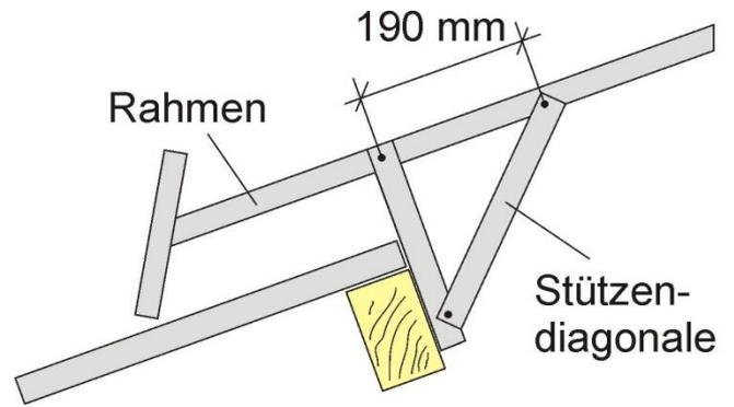
5. Al-Z-Pfetten gemäß Skizze auf den Rahmen legen und pro Auflager mit zwei SX5 Bohrerschrauben befestigen. Die Überlappung der Pfetten beträgt 120 mm und befindet sich genau auf einem Rahmen. Achten Sie auf die richtige Firstgröße und Anzahl der Pfettenreihen pro Seite.
