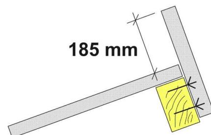
2. Schnur spannen und alle anderen Stützen ausrichten und ebenfalls mit je 2 bzw. 3 Bohrschrauben befestigen. Der Stützenabstand ist unbedingt einzuhalten und beträgt beim Deluxe Agrar Typ Halle **MLL 60 bis 200 - 1440 mm** (Mitte Stütze bis Mitte Stütze) und beim **MLL 225 bis 400 - 960 mm**.
